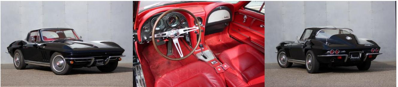
Die Chevrolet Corvette C2 wurde im Sommer 1962 als zweite Generation der Corvette unter dem Namen Sting Ray vorgestellt. Dieses Modell ist mit dem Small Block mit 5,4 Liter Hubraum und 300 PS ausgestattet. Gegenüber dem späteren 6,4 Liter „Big Block“ Motor deutlich spritziger, ist dieses Modell verbrauchseffizienter und hitzefest.
